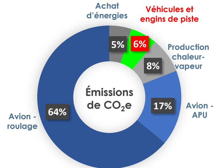
Source : ADEME, 2018, Répartition des émissions de CO<sub>2</sub> équivalent par poste d'émission (11 aéroports)
